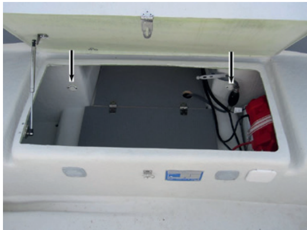
Kuva 7. HUOM! SUVI 63 DUO/DUO FISHER/CC FISHER, SUVI 57 CC FISHER, 57 DUO/DUO FISHER, SUVI 50 DUO/DUO FISHER, SUVI 47 DUO/DUO FISHER, SUVI 46 FISHER, SUVI 45 DUO, SUVI 44/eSuvi 44 malleissa kondenssiveden poistotulpat ovat takasäilytystilassa. (ks. kuva).
