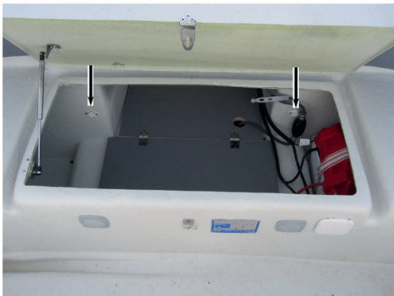
Bild 7. OBS! I modellerna SUVI 63 DUO/DUO FISHER, 63 CC FISHER, 57 CC FISHER, 57 DUO/DUO FISHER, 50 DUO/DUO FISHER, 47 DUO/DUO FISHER, 46 FISHER, 45 DUO, 44/eSuvi 44 finns tömningsproppen för kondensvatten i det bakre förvaringsutrymmet (se bilden).
