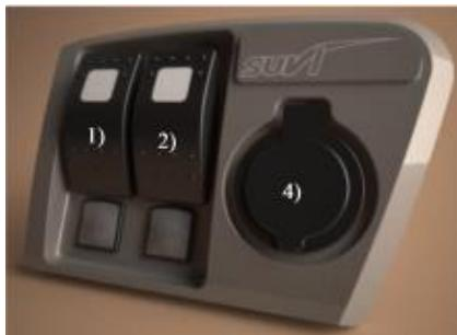
Kuva 10. SUVI 57 CC, 57 DUO, 50 DUO FISHER, 50 DUO, 47 DUO, 46, 45 DUO 4250 ja Meri-Palta CC mallien kytkinpaneeli.
