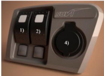
Bild 10. Brytarpanel för SUVI 5700 CC, 5750 DUO, 5080, 5050 DUO, 4750 DUO, 4650, 4540 DUO, 4250, Meri-Palta CC ja Meri-Palta 525.
