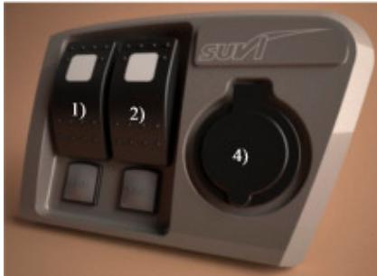
Kuva 8. SUIV 5700 CC, 5750 DUO, 5080, 5050 DUO, 4750 DUO, 4650, 4250, Meri-Palta CC ja Meri-Palta 525 mallien kytkinpaneeli.
