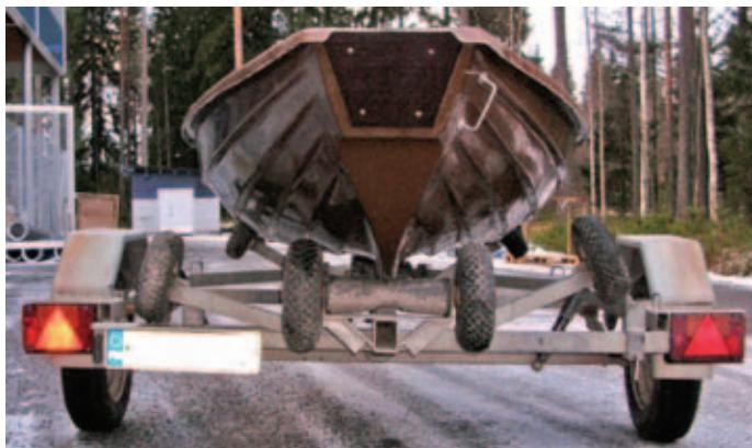
När båten dras av eller på trailern ska sidostöden vara nedfällda, så att rullarna inte klämmer åt båtens sidor och vikten hålls på kölen.
