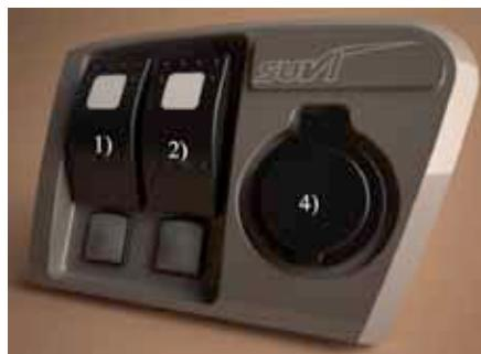
Bild 7. Brytarpanel för Suvi 5050 SR DUO, 5050 SR UNO, 5050 SR UNO CC, 4700 SR DUO, 4650 SR, 4250 SR och Meri-Palta CC.
