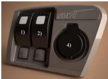
Kuva 5. Suvi 5050 SR DUO, 5050 SR UNO, 5050 SR UNO CC, 4650 SR, 4250 SR ja Meri-Palta CC mallien kytkinpaneeli.
