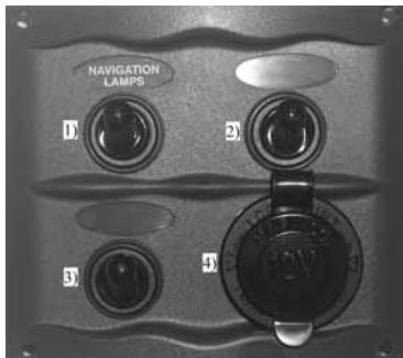
Bild 5. Brytarpanel för Suvi 4900 S DUO, 4900 S UNO, 4550 S och Meri-Palta.
